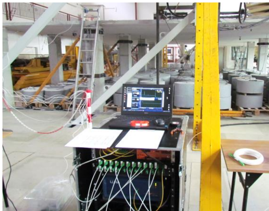
Fot. 12 Widok stanowiska do pomiaru DFOS i kamer systemu Aramis
