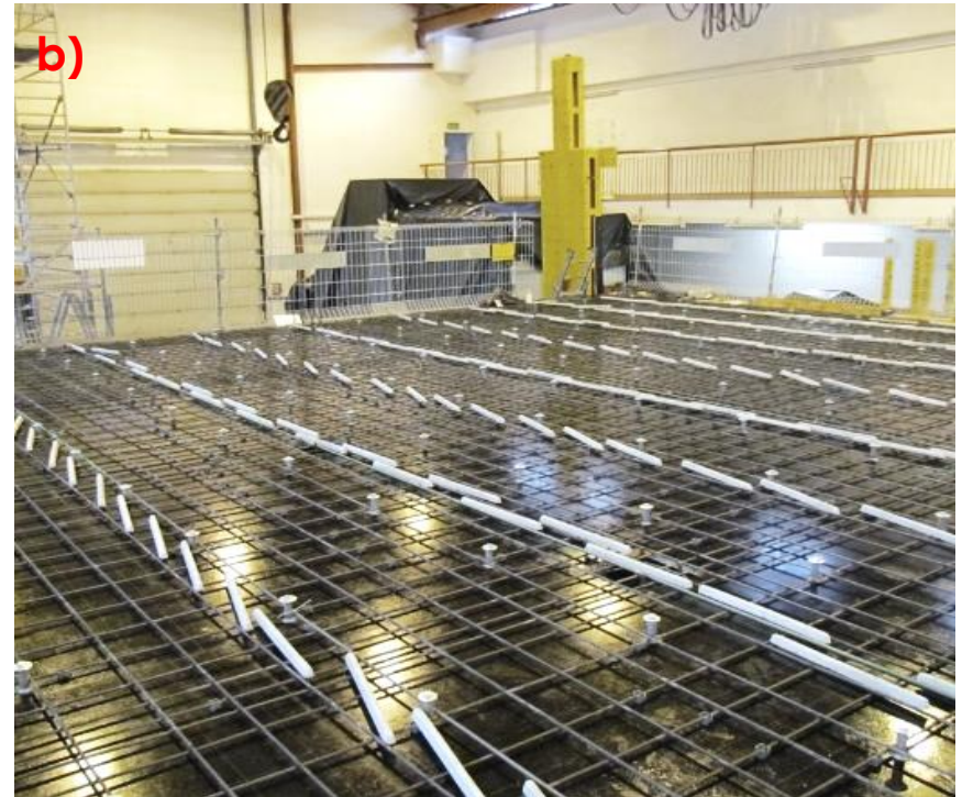
Fot. 1 Widok analizowanego stropu płytowo-słupowego: a) model w trakcie badań; b) widok zbrojenie dolnego w trakcie realizacji elementu badawczego.
