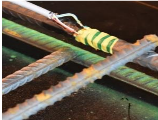
Fot. 9 Widok włókien światłowodowych i tensometrów na prętach zbrojeniowych
