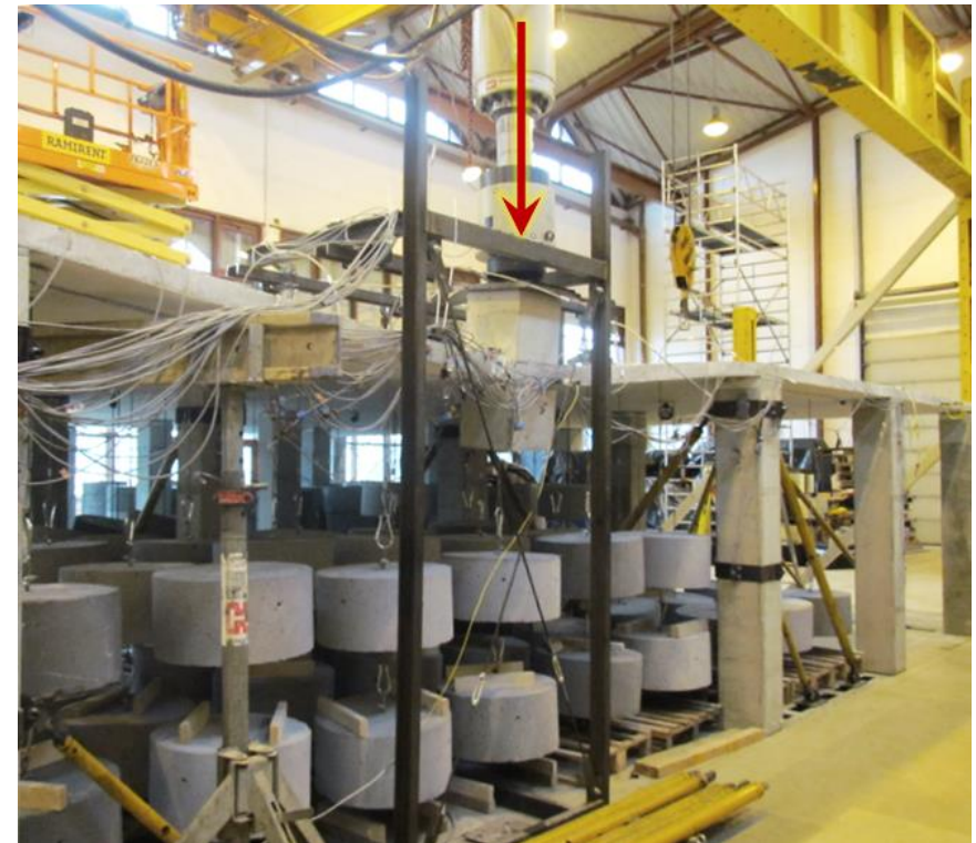
Fot. 2 Widok mechanizmów obciążania badanego układu płytowo – słupowego
