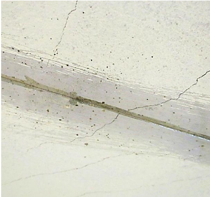
Rys. 8 Włókna światłowodowe na powierzchni betonu: widok rzeczywisty i schemat rozmieszczenia [1]
