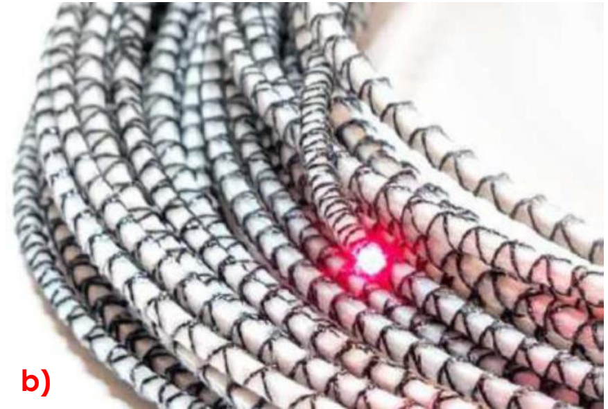
Fot 4 Czujniki światłowodowe [2]: a) światłowodowy czujnik EpsilonRebar o wysokim module sprężystości, b) czujnik EpsilonSensor o niskim module sprężystości
