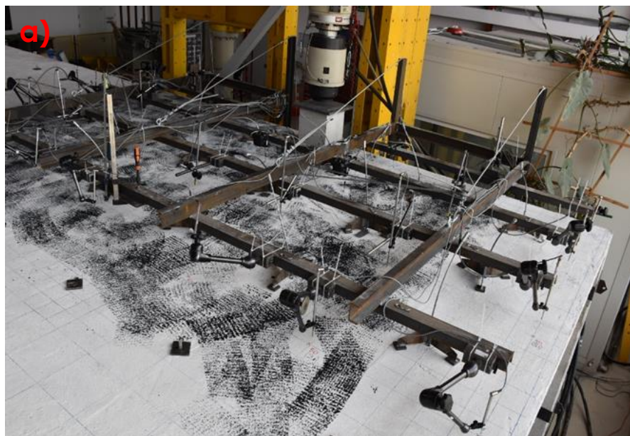
Fot. 3 Techniki pomiarowe: a) widok konstrukcji wsporczej wraz indukcyjnymi czujnikami przemieszczeń, b) widok tensometru elektrooporowego na zbrojeniu (przed betonowaniem)
