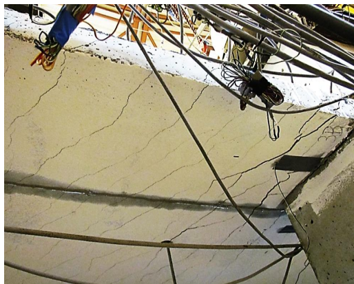
Fot. 11 Widok włókien światłowodowych modelu MES płyty
