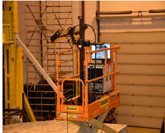
Fot. 12 Widok stanowiska do pomiaru DFOS i kamer systemu Aramis
