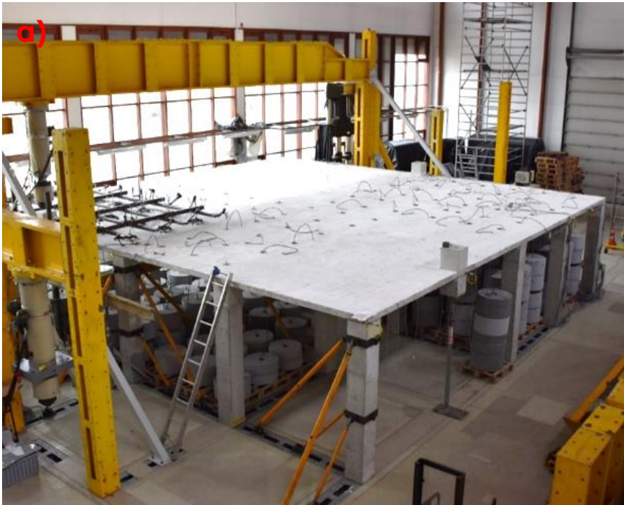
Fot. 1 Widok analizowanego stropu płytowo-słupowego: a) model w trakcie badań; b) widok zbrojenie dolnego w trakcie realizacji elementu badawczego.
