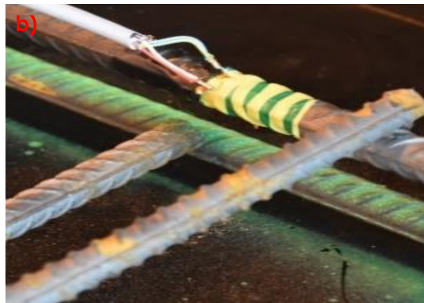
Fot. 3 Techniki pomiarowe: a) widok konstrukcji wsporczej wraz indukcyjnymi czujnikami przemieszczeń, b) widok tensometru elektrooporowego na zbrojeniu (przed betonowaniem)
