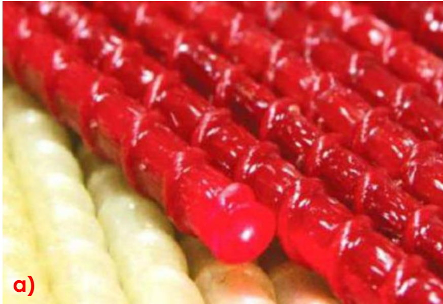
Fot 4 Czujniki światłowodowe [2]: a) światłowodowy czujnik EpsilonRebar o wysokim module sprężystości, b) czujnik EpsilonSensor o niskim module sprężystości
