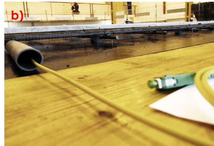
Fot. 6 Włókna światłowodowe: a) widok włókna pomiarowego w siatce zbrojenia dolnego płyty, b) widok pigtaila w rurze ochronnej
