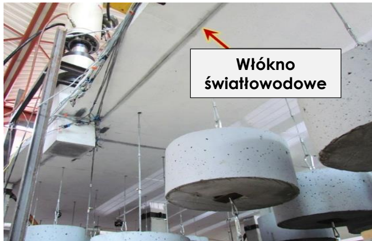
Fot. 7 Włókna światłowodowe przyklejone do dolnej powierzchni płyty [1]
