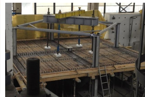
Element próbnny przed i po wylaniu płyty żelbetowej
